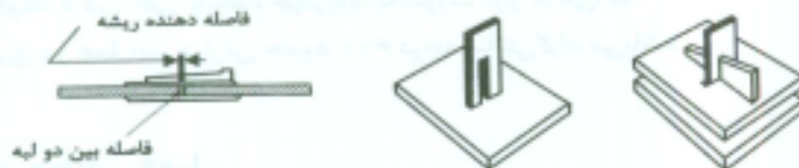
شکل ۶-۱۸ هم راستا نمودن ورق ها و حفظ هم راستایی در لبه های آنها به کمک گیره و گوه.
