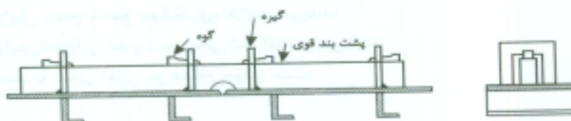
استفاده از گوه برای ورق های نازک
