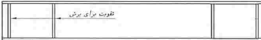
شکل ۲-۴-۳- اضافه نمودن ورق‌های سخت‌کننده عرضی
