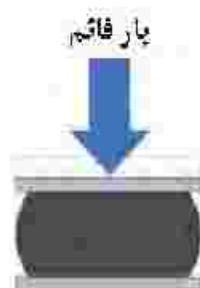
شکل ۵-۶- تغییر شکل قائم جداگر لاستیکی خالص
