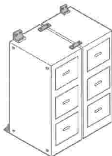
شکل ۱۰-۷- مهار قفسه با اتصال دیوار
