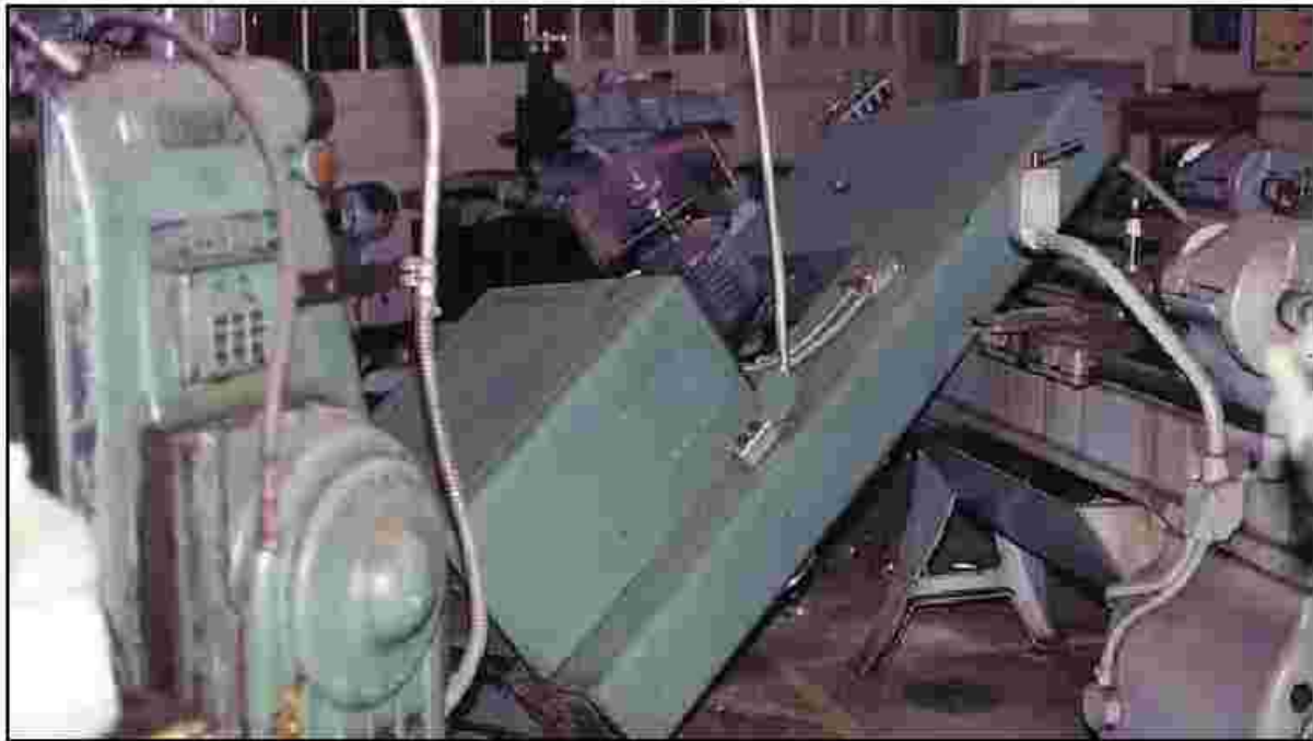
شکل ۱-۱۰ - واژگونی تجهیزات سنگین در هنگام زلزله
