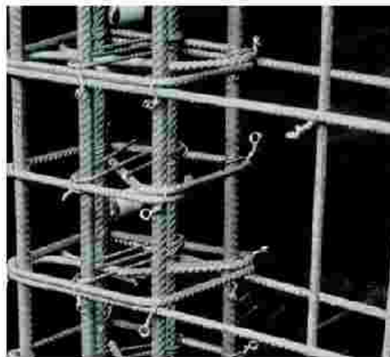
شکل ۳-۱۶- اجرای جزئیات مناسب و شکل‌پذیر در ستون‌ها
