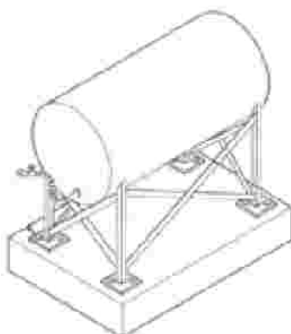
شکل ۱۰-۱۷- مهاربندی تانک‌های افقی
