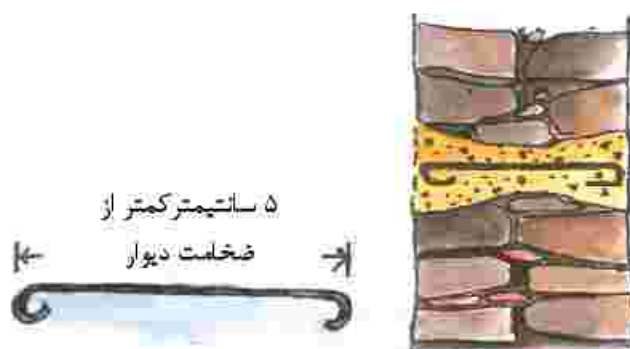
شکل ۹-۳ دو طرف میلگرد داخل عضو همبند باید بصورت قلاب باشد
