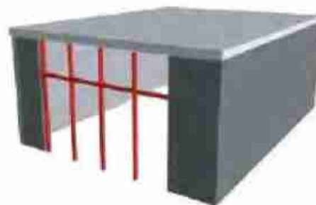
الف- اضافه کردن دیوارهای سازه ای
